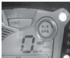
**4WD LOCK:** привод на четыре колеса с блокировкой переднего и заднего дифференциалов. Квадроцикл в режиме полного привода с блокировкой переднего и заднего дифференциалов, что означает, что все четыре колеса работают без дифференциала. Мощность передается на передние и задние колеса без работы дифференциала. Обеспечивает сцепление всех четырех колес и должно использоваться при пробуксовке двух и более колес.
