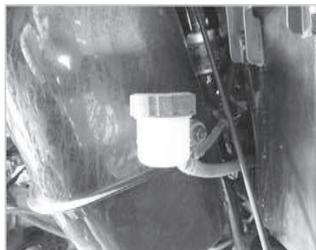
**Для модели Т3:** При падении уровня тормозной жидкости НИЖЕ отметки MIN загорится сигнал предупреждения и необходимо будет долить тормозную жидкость.
