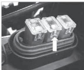
На моделях без EPS предохранитель MAXI находится рядом с реле стартера.
