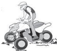
Движение по наклонной поверхности требует правильного размещения вашего веса на квадроцикле для поддержания корректного баланса. Убедитесь, что вы усвоили базовые техники вождения на ровной местности перед тем, как начинать ездить по склонам. Избегайте склонов со скользкой поверхностью или сложной местности, которые могут привести к потере равновесия.
