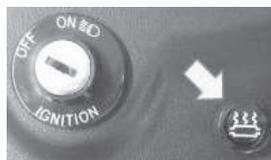
При включении этой лампочки необходимо заглушить двигатель и выключить зажигание. Дождитесь охлаждения двигателя и выключения лампочки, а затем заново запустите двигатель.
