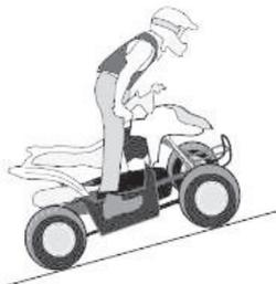
Не пытайтесь двигаться по склонам до тех пор, пока не отточите основные маневры на ровной поверхности. Перед началом подъема внимательно исследуйте рельеф местности. В любом случае избегайте склонов со скользкой или рыхлой поверхностью или препятствиями, которые могут стать причиной потери управления.
