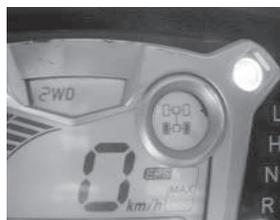
**2WD LOCK:** привод на задние колеса с блокировкой заднего дифференциала
