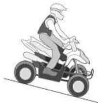
При движении вниз по склону перенесите свой вес максимально назад и в сторону вершины холма насколько это возможно. Сдвиньтесь назад на сиденье так, чтобы руки были прямыми. Торможение двигателем сделает за вас основную работу. Для максимального эффекта торможения двигателем включите пониженную передачу и включите режим “4WD” перед началом спуска по склону.
