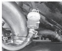
На топливном баке есть контрольная емкость для проверки топлива в момент заливки.
