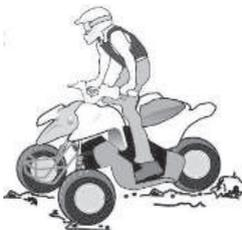
Движение по наклонной поверхности требует правильного размещения вашего веса на квадроцикле для поддержания корректного баланса. Убедитесь, что вы усвоили базовые техники вождения на ровной местности перед тем, как начинать ездить по склонам. Избегайте склонов со скользкой поверхностью или сложной местности, которые могут привести к потере равновесия.
