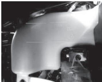
Если уровень жидкости находится на отметке Min или ниже, открутите заливную горловину, долейте охлаждающей жидкости или дистиллированной воды до отметки Max и закрутите крышку обратно.
