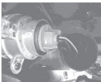
2. Отсоедините держатель лампы стоп-сигнала (вместе с лампой), повернув его против часовой стрелки.
