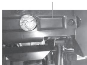
3. Открутите болт для заливки масла, сливной болт и прокладку для слива масла.
