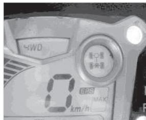
**4WD LOCK:** привод на четыре колеса с блокировкой переднего и заднего дифференциала.
