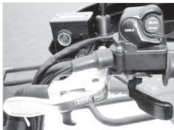
Для проверки или регулировки оборотов переместите рычаг КПП в положение N.
