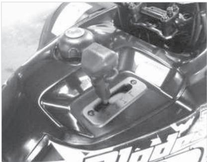
Работа с высоким моментом оборотах (пониженная передача)
