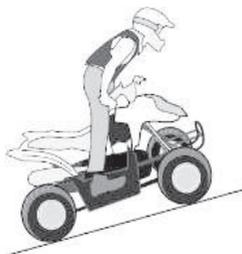
Для движения вверх по склону требуется сцепление, импульс движения и непрерывная работа акселератора. Для повышения сцепления и управляемости при движении по крутым и/или сложным склонам, используйте режим движения "4WD" или 4WD-LOCK. Двигайтесь достаточно быстро для сохранения импульса движения, однако не слишком быстро, чтобы иметь возможность реагировать на изменения рельефа.
