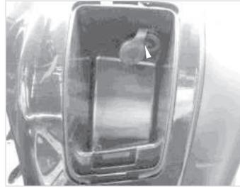
1. Поверните выключатель фар в положение ВЫКЛ (OFF).
